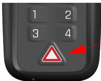
Fig. 7 – Generazione allarme manuale
